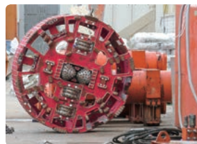
▲ 泥水式推進工法 カッターヘッド
